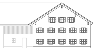
exemplarische Skizzen: Allgäuer Hofstelle mit Wiederkehr, hieraus ergibt sich ein Gebäudeensemble in T- Form oder L- Form.
